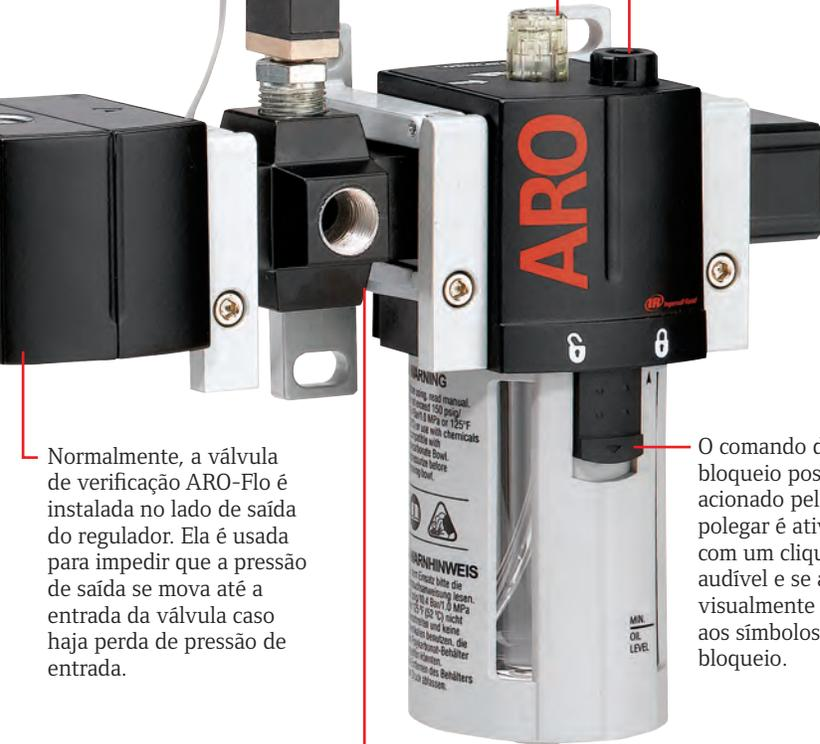
Normalmente, a válvula de verificação ARO-Flo é instalada no lado de saída do regulador. Ela é usada para impedir que a pressão de saída se mova até a entrada da válvula caso haja perda de pressão de entrada.
